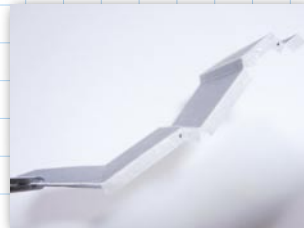
36、横をボンドで接着して、固定します。
